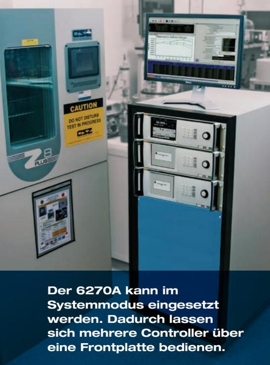
**Der 6270A kann im Systemmodus eingesetzt werden. Dadurch lassen sich mehrere Controller über eine Frontplatte bedienen.**
